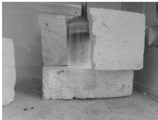
Рис. 1. Кварцевый бюкс, теплоизолированный шамотом, в СВЧ-печи. Хорошо видно свечение раскаленного угля внутри бюкса, а также СВЧ-волновод (справа)
